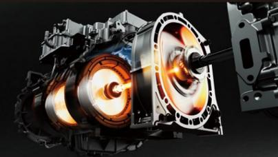
ロータリーエンジンを発電機として使用した理由は、「省スペース性」。「省スペース性」を活かし、125kwを発生する高出力モーターを搭載
